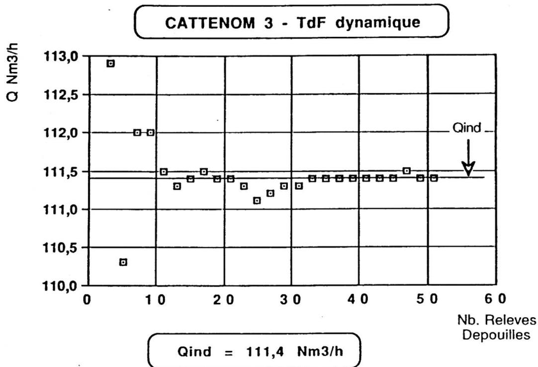
Figure 6 : Incidence du nombre de relevés dépouillés sur la détermination du débit de fuites "indirectes".
