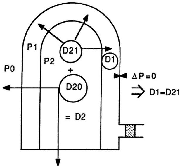
L'enceinte interne étant pressurisée à la pression nominale d'essai, on dépressurise l'espace entre-enceinte à environ - 10 mbar, puis on isole l'ensemble. Lorsque l'équivalence entre P0 et P1 est réalisée, l'échange gazeux avec l'extérieur ne se fait plus que par les fuites "directes". Si on mesure simultanément les débits de fuites globaux D2 et D1 à l'instant précis où  $\Delta P = 0$ , on obtient le débit de fuites "directes" D20 par différence :
