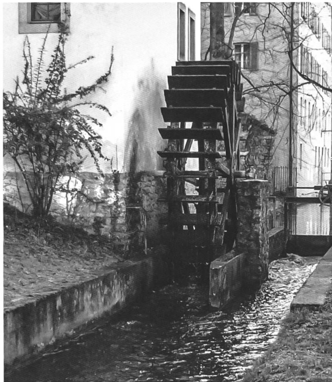
Schaufelrad bei der Aarauer Schloßmühle. Auch die Hermetschwiler Klostermühle wurde von einem stehenden Schaufelrad angetrieben. Der Wirkungsgrad eines solchen Rades war wesentlich höher als bei Stockmühlen mit liegendem Rad.
