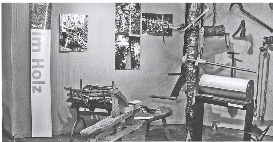
In der Ausstellung «Im Holz. Wald, Holz und Bürgerstolz» von 2003 waren auch zahlreiche alte Werkzeuge der Holzwirtschaft zu sehen. Die Walze rechts im Bild diente zur Berechnung des Kubikinhalts von Baumstämmen. Foto Peter Spalinger.
