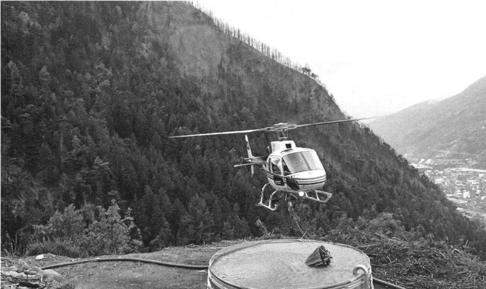
Ausgleichsbecken als Wasserbezugsort für Löschhelikopter Waldrand Visp.
