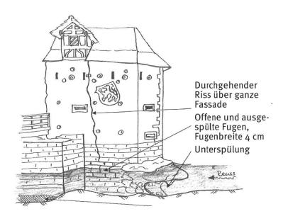
Die Schäden am Fundament des Bollhauses unter der Nordund Südfassade
