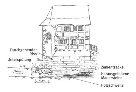
Gestützt auf diesen Expertenbericht wurde das Bollhaus aus Sicherheitsgründen vorübergehend geschlossen. Um das Gebäude zu sichern, füllten Taucher im Juni 2009 als Sofortmassnahme die Hohlräume unter Wasser mit zementgefüllten Kunststoffsäcken aus.
