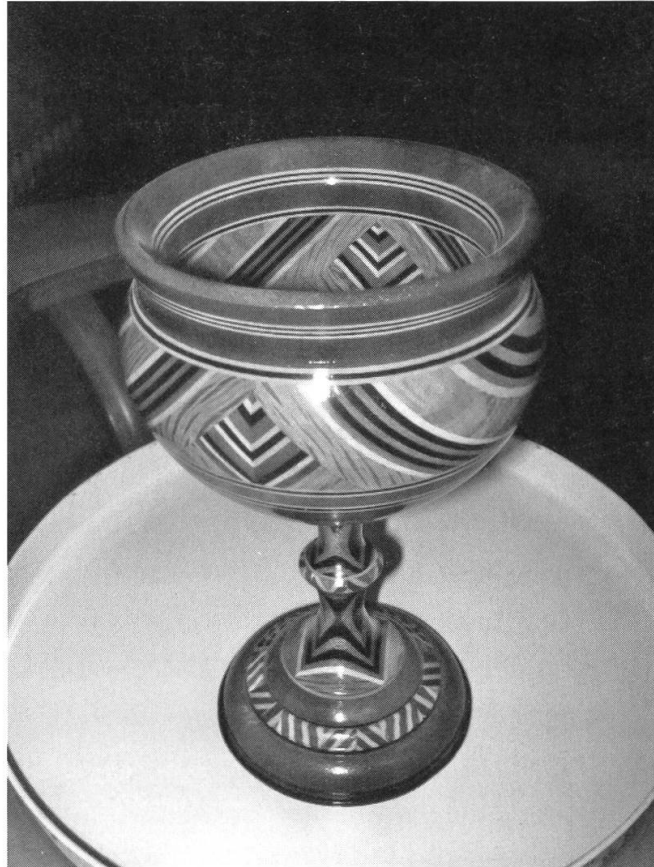
Holzkelch aus verschiedenfarbigen, verleimten Hölzern, auf der Drechslerbank ausgehöhlt und geformt.
