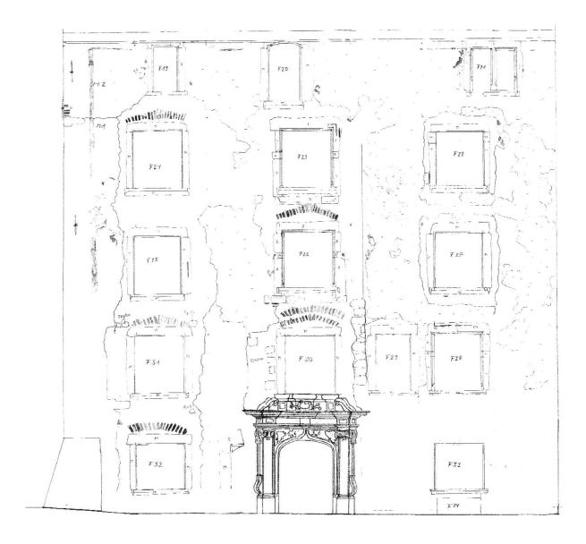
Bauaufnahmeplan der Westfassade mit der erkennbaren vertikalen Baunaht des Anbaus von vermutlich 1526/28 und den Befundspuren der Ecklisenenmalerei, der Mondsichelmadonna und der Sonne. (Kantonsarchäologie Aargau, Peter Frey)
