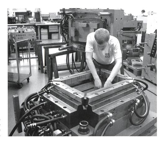
Hochpräzise Spritzgusswerkzeuge werden im eigenen Werkzeugbau gefertigt.
