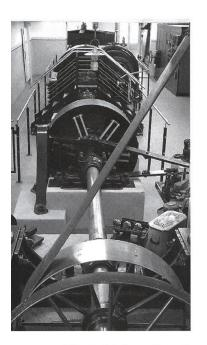
Die Antriebswelle mit Kupplung und Riemenantrieb des Turbinenreglers.
