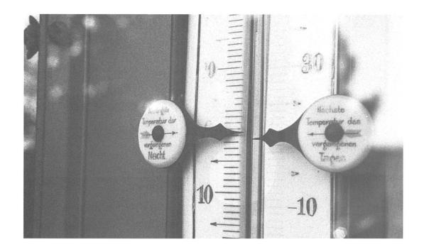
eines Magneten auf die aktuelle Temperatur eingestellt. Mit den beschrifteten Schiebzeigern lassen sich letztes Minimum und Maximum festhalten.
