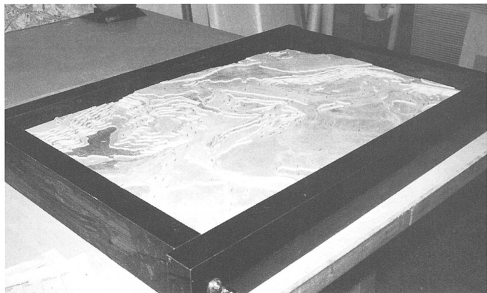
Das Treppenstufenmodell in einem Präzisionsrahmen (exakter rechter Winkel) zum Abguss bereit.
