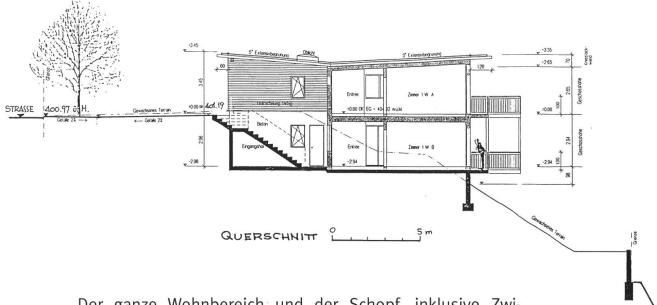
Der ganze Wohnbereich und der Schopf, inklusive Zwischendecke und Dach, wurden in Holzrahmen-Systembauweise erstellt. Diesem Holzbausystem ist eigen, dass fast alle Balken und Tafeln aus verleimten Brettschichten bestehen, um das normale Schwinden, Reissen, Biegen, Wachsen und Verdrehen auf ein Minimum zu reduzieren.
