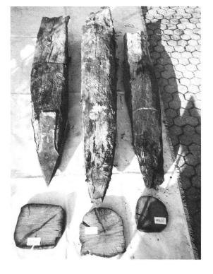
Abb. 5: Die Pfähle nach der dendrochronologischen Altersbestimmung im Februar 1999.
