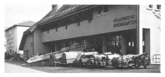
Von links nach rechts: Stahlleiter (Ehrsam) 1966; Schlauchwagen (Ehrsam) 1953; Schlauchverlegewagen (ZS/Contraten) 1975; Motorspritze (Diebold) 1941 (Reserve); Motorspritze Vogt 1962; Schlauchwagen Ehrsam 1963; Staubanhänger Primus 1962
