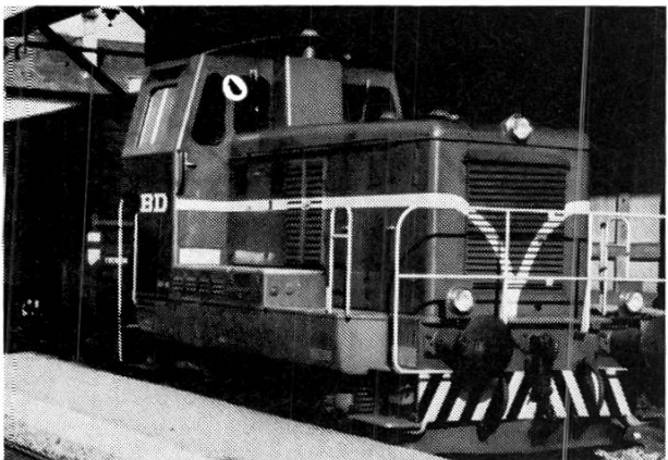
Diesellokomotive für Güterzüge Bremgarten-West—Wohlen. BDB Em 2/2 102. Baujahr: 1966. 1968 Uebernahme von WM. Tara: 39,0 t. Länge: 7,5 m. Geschwindigkeit: 55 km/h. Leistung: 330 PS. Heute noch im Güterzugsdienst eingeteilt.
