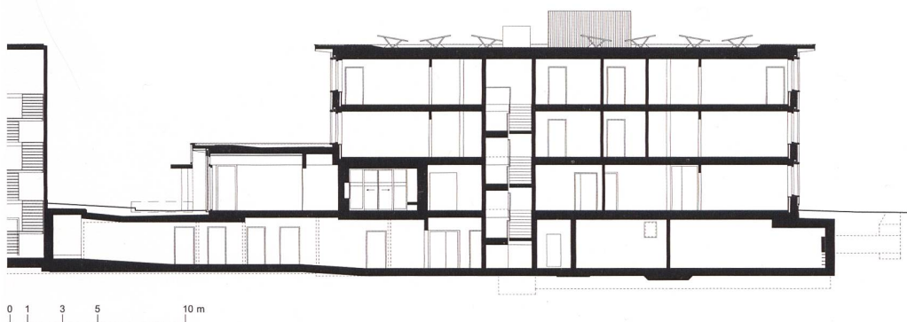
Schnitt durch die Anbindung an den Hauptbau im Untergeschoss
