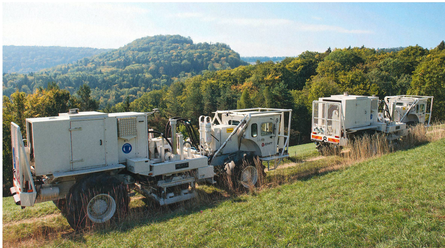
Start der Messkampagne war in Mandach / Villigen. Die Vibrationsfahrzeuge fahren von Anregungspunkt zu Anregungspunkt. Dabei wird alle 30 Meter vibriert. Quelle: Ernst Müller
