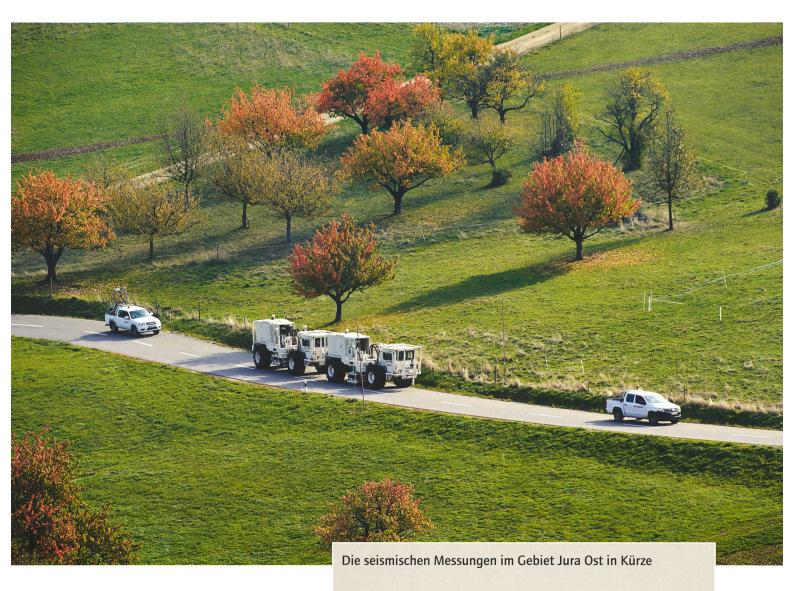
Am 1. Oktober 2015 starteten die seismischen Messungen in Mandach / Villigen. Mit jeweils zwei Fahrzeugen wurde an den einzelnen Messpunkten vibriert.
