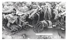
Abbildung 6 (links) Rasterelektronenmikroskopische Aufnahme von haarförmigen Salzkristallen, die eine Malschicht abstossen.
