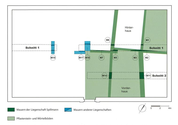
Grundriss des ehemaligen Kornhauses. Ausgegrabene Grundmauern der Gebäude nach der Zerstörung 1444. Kantonsarchäologie Aargau Zeichnung: Theo Frey
