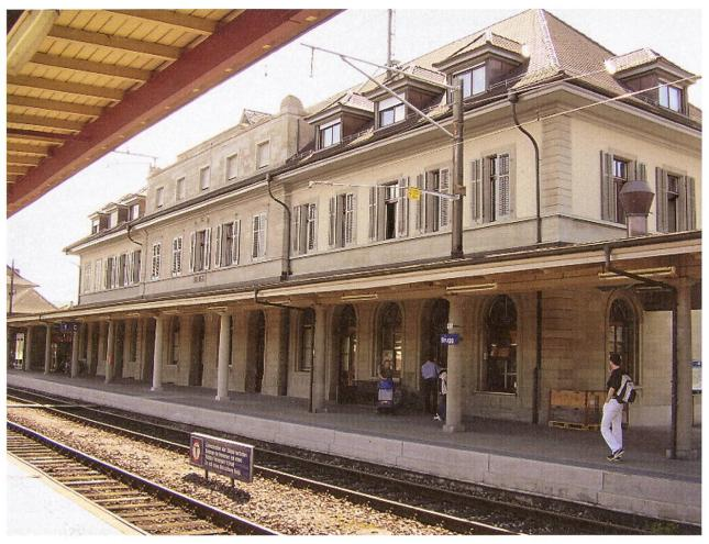
Gleisseitige Ansicht des Aufnahmegebäudes in Brugg (Aufnahme 2005). Das Befehlswerk auf Perron 1 wurde entfernt zu Gunsten eines freien Durchgangs für das Publikum. Zwei neue runde Tragsäulen mussten angefertigt werden; sie befinden sich in der Mitte, sind heller und daher deutlich zu erkennen. Foto: Gregor Tomasi
