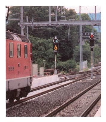
Die neue Signalisierung zeigt am linken Signal einen grünen Lichtpunkt mit der Ziffernanzeige «6». Diese Zahl muss mit 10 multipliziert werden was eine Höchstgeschwindigkeit von 60 km/h ergibt. Die Lichtpunkte zeigen nur noch Rot (Halt), Orange (Warnung) und Grün (Fahrt nach Angaben am Signal oder gemäss Dienstfahrplan des Lokomotivführers).
