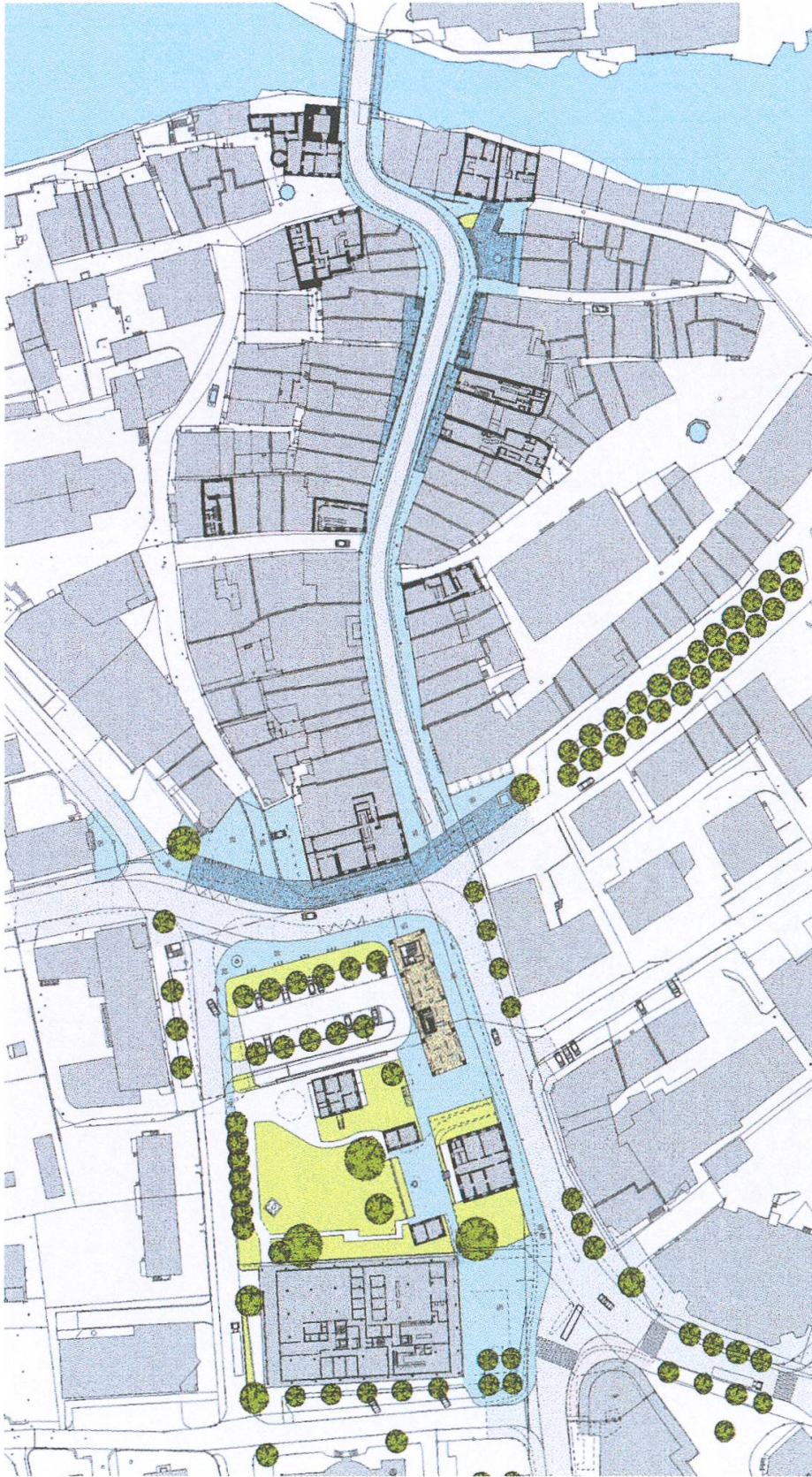
September 2001: Das Projekt «CityPlus» in der Übersicht, vom nördlichen Eingang zur Altstadt (rechts) bis zum Lindenplatz. In Bau: gepflasterte Flächen. Bildmitte, in dunklerem Blau: Ein Band aus Granitplatten erinnert an den einstigen Stadtgraben.
