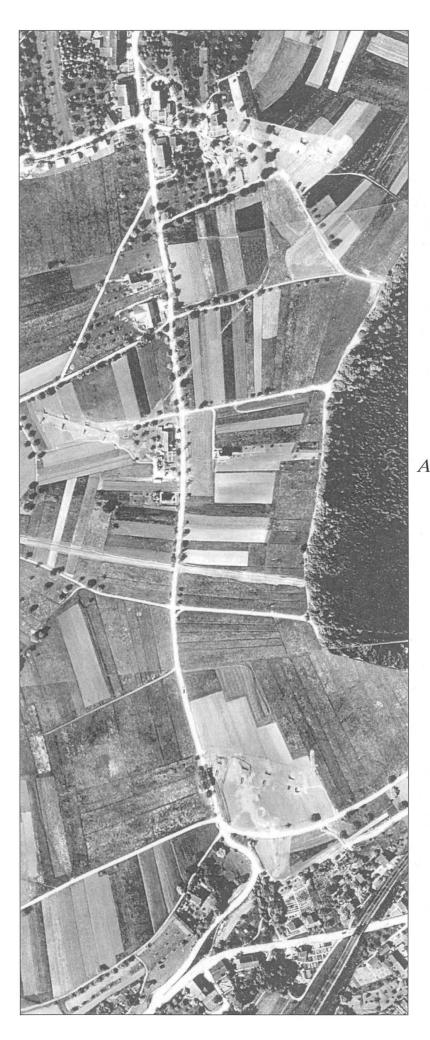
Abb. 19 Artilleriestellungen Riniken. Zusammensetzung von drei Luftaufnahmen vom 20. Mai 1940. Rechts unten die Bözbergbahnlinie, am oberen Bildrand der Dorfeingang von Riniken. Überdeckte Rundholzstellungen für je vier Feldkanonen 7,5 cm der Batterien 37, 38, 39 (Feldartillerie-Abteilung 15); breite Auschuss-Scharten gegen oben, schmale Einfahrten unten, je mit überdeckten Verbindungsgräben zwischen den Geschützen und zu den Unterständen für Batterieleitung und Munition.
