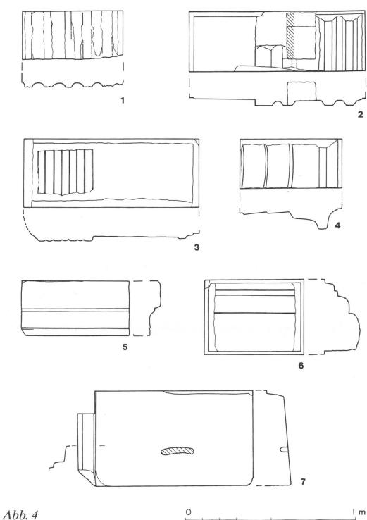
Schwarzer Turm. Auswahl von römischen Spolien, Ansichten und Profile. 1–3: Pilaster mit Kanneluren; 4: Profilierter Keilstein eines Bogens; 5–7: Profilierte Gesims- bzw. Basissteine. Massstab 1:20. Zeichnungen: E. Wullschleger/Andreas Motschi, Kantonsarchäologie Aargau
