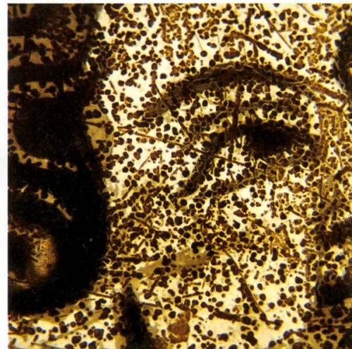
Abb. 10 s III, 11c; starker rückseitiger- Lochfrass, im Durchlicht
