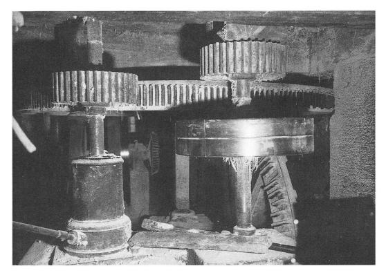
Abb. 23: Stirnradgetriebe in der mittleren Mühle von Schinznach-Dorf.
