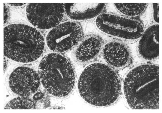
Fig. 2: Dünnschliffbild aus der Hauptrogenstein-Formation. Man erkennt gut die Lagenstruktur der Ooide sowie einzelne Ooidkerne. Zwischen den Komponenten wurden während der Gesteinsbildung (Diagenese) Kalzitkristalle abgeschieden, die nun einen durchsichtigen Zement bilden, der die Komponenten zum Gestein zusammenbindet. (Foto: Dr. G. Strub, Basel)
