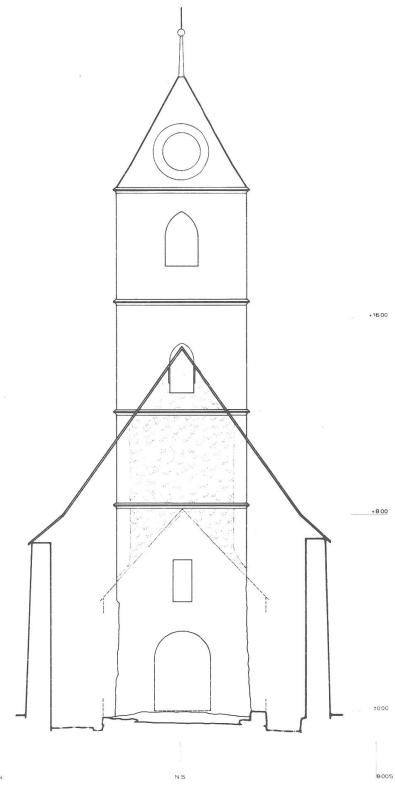
3 Schnitt durch heutige Kirche mit Ostansicht des Turmes. Eingetragen sind die Mauerzüge der ersten Kirche, der genaue Kantenverlauf am Turmerdgeschoss, Dachschräge der gotischen Kirche, verputzte Turmfläche und Schallfenster im 3. Turmgeschoss.
