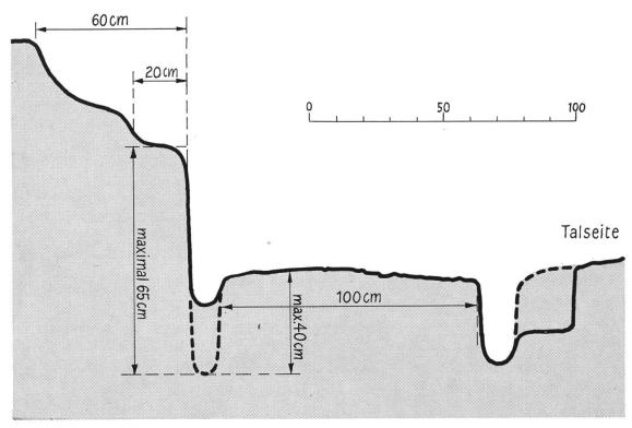
Abb. 3. Effingen, Windischtal. Querschnitt durch die «Römerstrasse» im Fels (vgl. Abb. 2, Strasse 2, A).
