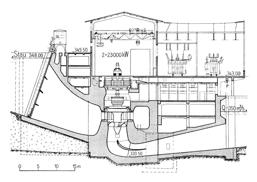
Kraftwerk Wildegg-Brugg — Maschinenhaus. Querschnitt
