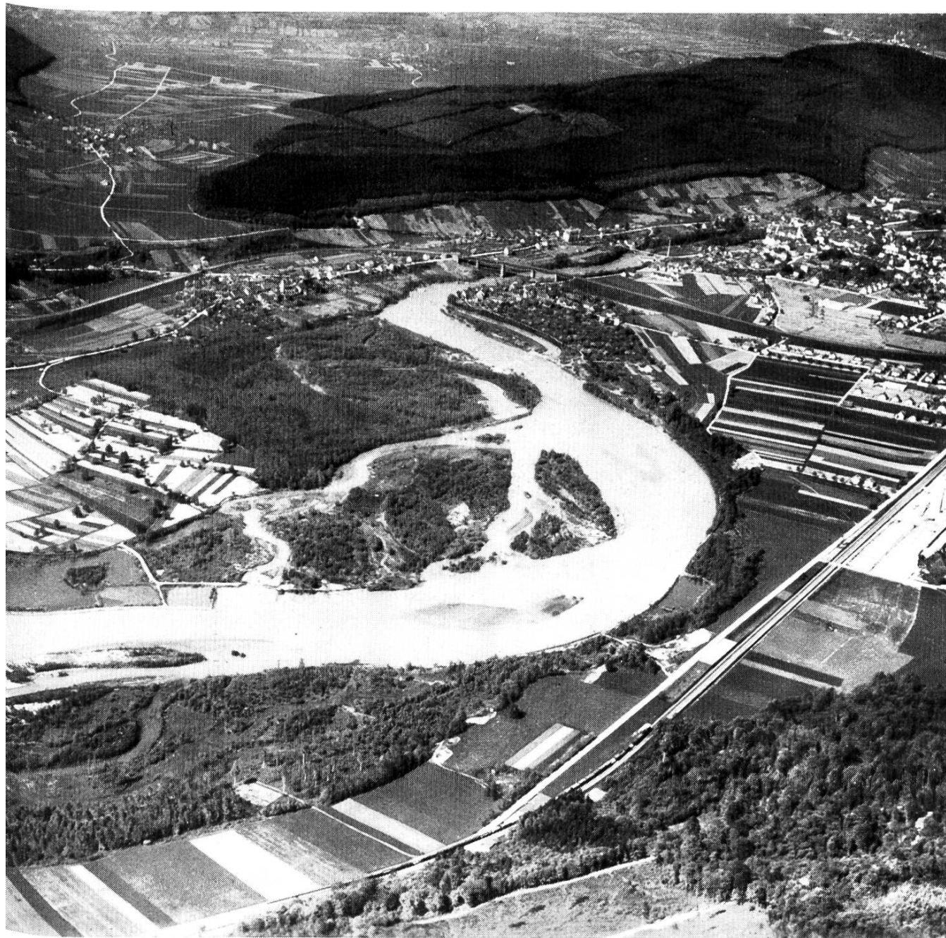
Abb. 1. — Das Fliegerbild zeigt sehr schön an der scharfen Linie des rechten Ufers die zentrifugal wirkende Erosionstendenz des Flusses, durch welche die Niederwasser-schotterfläche angegriffen wird. Im inneren Bogen läßt sich die Dynamik der Überströmungsfläche mit ihren Gießen und Inseln erkennen. In dieser Kampfzone finden sich alle Stadien des Aufbaues der Auenvegetation durchfurcht und wieder zerstört durch den Einbruch des jährlichen Hochwassers.
