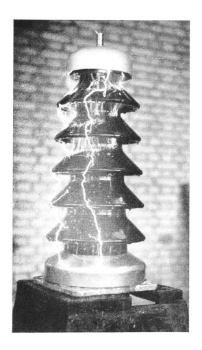
Abb. 3a (links). Ueberschlag eines Kabelendverschlusses bei ca. — 600 000 Volt
