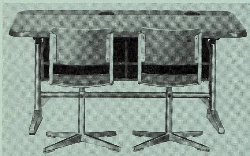
Plateau 120 x 56 cm, revêtement de bois compressé (placage tranché) ou avec revêtement de stratifié; réglable en hauteur avec engrenage ou au moyen de crans d'arrêt et de ressorts d'élévation. Plateau horizontal fixe ou inclinable.
