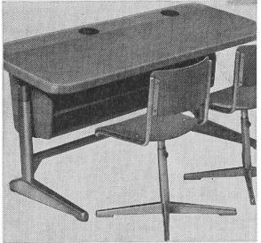
Plateau de table 120 x 53 cm, en bois pressé, avec placage déroulé ou tranché ou avec revêtement de résine synthétique, réglage en hauteur par l'engrenage Embru ou le mécanisme à ressorts et vis de serrage, avec ou sans réglage d'inclinaison du plateau.
