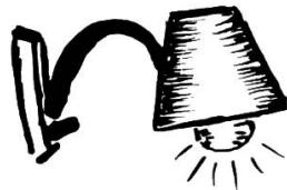
Approcher la lampe de chevet à la verticale et à environ 40 cm. Provoquer un éclair de une à trois secondes; cherchez vous-mêmes le temps de pose exact, celui-ci étant inversement proportionnel à la force de la lampe.
