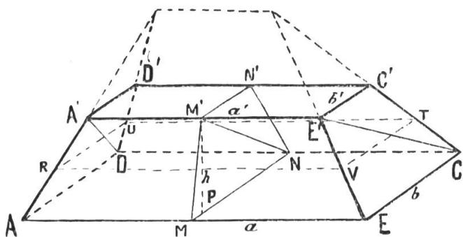
$$\begin{aligned} &= \frac{h}{6} [ab + a'b' + (a + a')(b + b')] \\ &= \frac{h}{6} \left[ ab + a'b' + 4 \left( \frac{a + a'}{2} \right) \left( \frac{b + b'}{2} \right) \right] \end{aligned}$$
