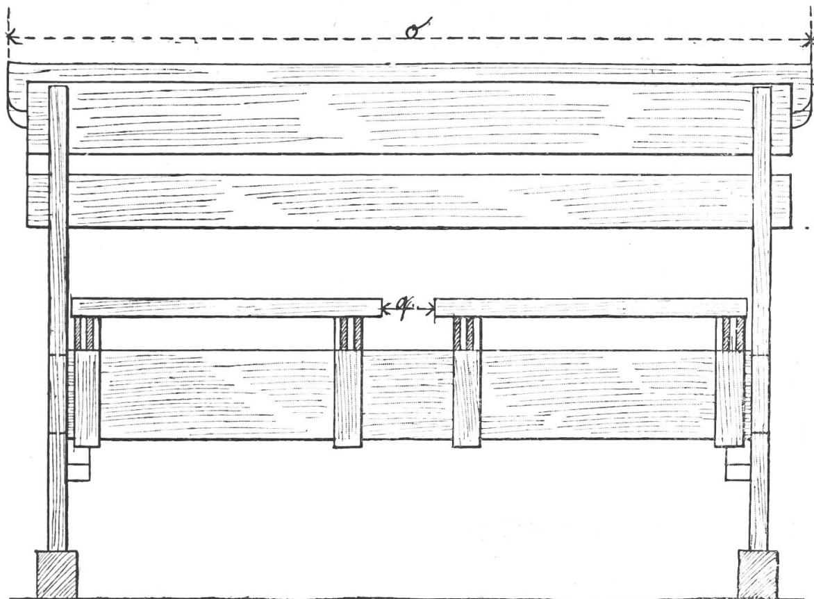
8. La table supérieure du banc recevra une inclinaison d'environ le sixième de sa largeur.
