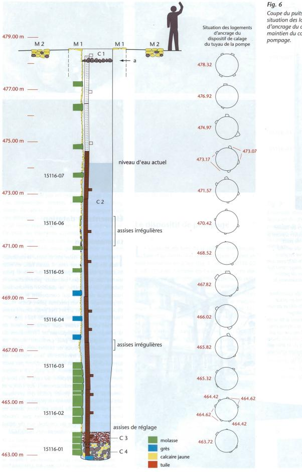
Coupe du puits, avec la situation des logements d'ancrage du dispositif de maintien du conduit de
