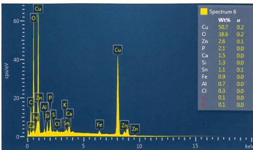
analysées en 22 points<sup>16</sup>. La présence récurrente de cuivre, d'un peu de zinc et parfois d'étain a permis d'identifier un alliage cuivreux contenant du zinc, possiblement du laiton (fig. 3)<sup>17</sup>.
