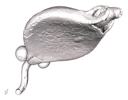
Fig. 9 Vue 3D (imagerie neutrons) de la partie inférieure du bracelet-étui. Une petite cloque est visible sur la tôle de fermeture. E. Lehmann, D. Mannes, PSI.
