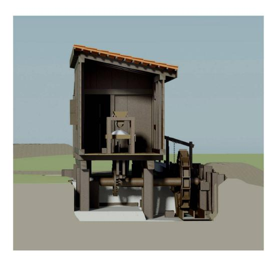
régulation du débit d'amenée est complété par une vanne en amont, permettant de désactiver la roue au besoin.
