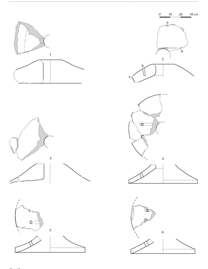
**Fig. 42**Moulin hydraulique des Tourbières. Les meules. 1-2: granit; 3-6: lave vacuolaire. Échelle 1:10.
