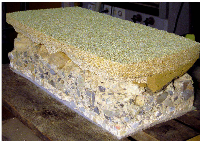
Fig. 13 Échantillon d'un sol en terrazzo, à l'envers avec son nouveau support.
