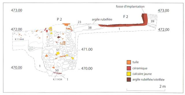
Fig. 23. Avenches À la Montagne. Coupe stratigraphique du puits P 2 et du four F 2, vue nord.
