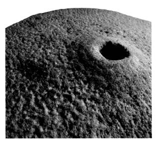
Fig. 13. Vue de détail de la meta en grès cat. 57. Les traces du «repiquage» de la surface active sont clairement visibles.
