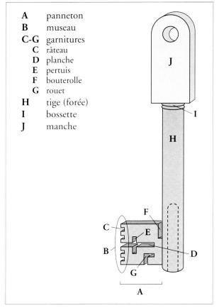
Fig. 2. Clef à panneton. Dénomination des différentes parties.
