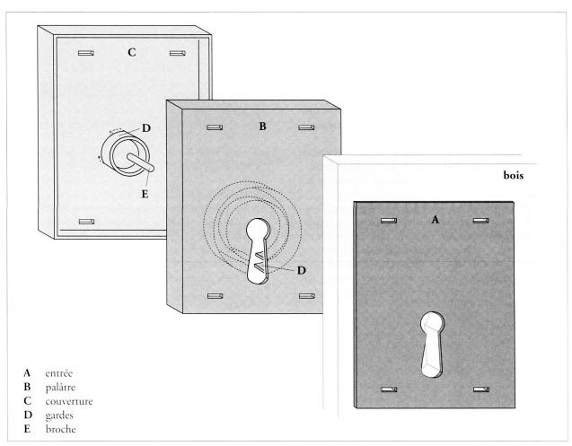
Fig. 1. Serrure à rotation. Dénomination des différentes parties.
