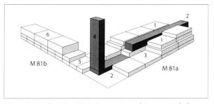
Fig. 13. Insula 12, 1986. Restitution schématique de l'appareil du mur d'angle M 81a-b de l'unité B (cf. fig. 10). 1: double rangée de briques crues carrées (tetradoron). 2: poutres horizontales et lit de briques crues intercalaire (3). 4: poteau d'angle (cornier). 5: assises inférieures de briques «lydiennes» disposées en boutisses parpaignes. 6: lit de carreaux disposés à plat.
