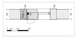
Fig. 2. Proposition de restitution schématique du seuil dans sa position originale. En grisé, le fragment conservé; l'inscription se trouve ici sur une partie de la dalle encastrée dans la maçonnerie. 1: crapaudine. 2: mur. 3: chambranle. Dessin J.-P. Dal Bianco, MRA.
