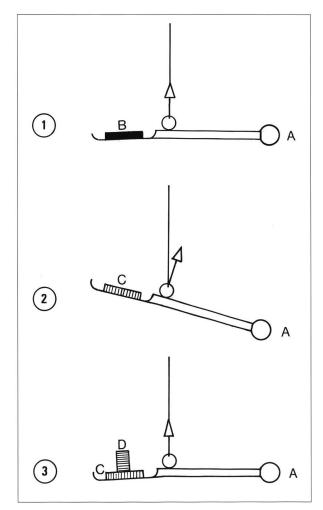
Fig. 3. Schéma du fonctionnement d'une balance à tare fixe. Dessin M. Aubert, MRA.
