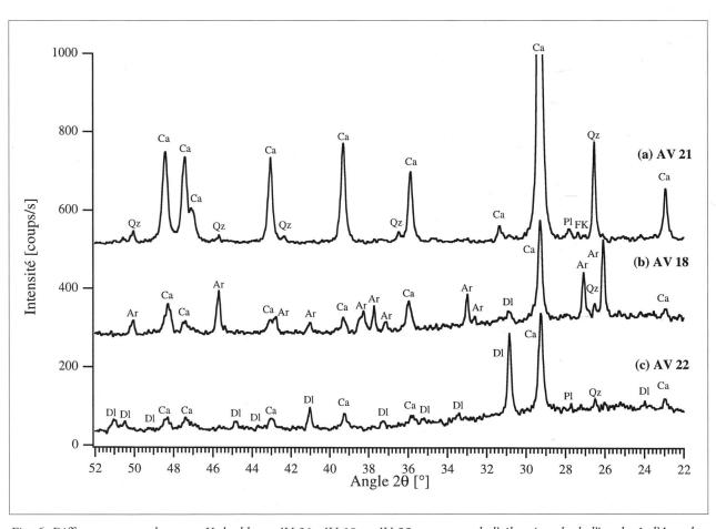
Fig. 6. Diffractogrammes de rayons X des blancs AV 21, AV 18 et AV 22 provenant de l'aile orientale de l'insula 1 d'Avenches, identifiant respectivement: (a) la calcite (une craie); (b) l'aragonite; (c) la dolomite. Ar = aragonite; Ca = calcite; Dl = dolomite; FK = feldspath potassique; Pl = plagioclase; Qz = quartz.
