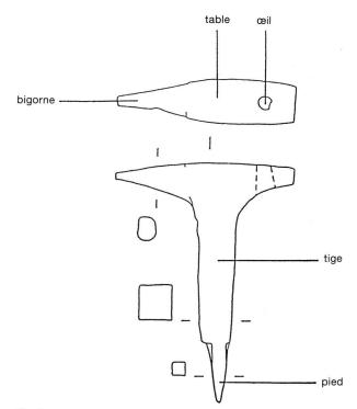
Fig. 1 Les différentes parties d'une enclume
