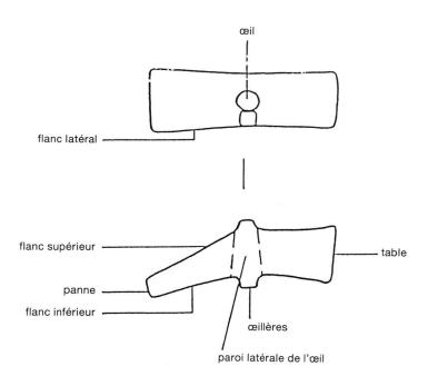
Fig. 2 Les différentes parties d'un marteau
