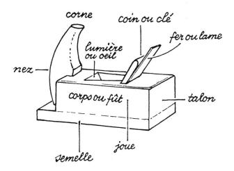
Fig. 11 Les différentes parties d'un rabot
