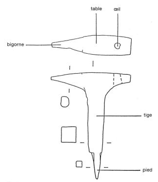
Fig. 1 Les différentes parties d'une enclume
