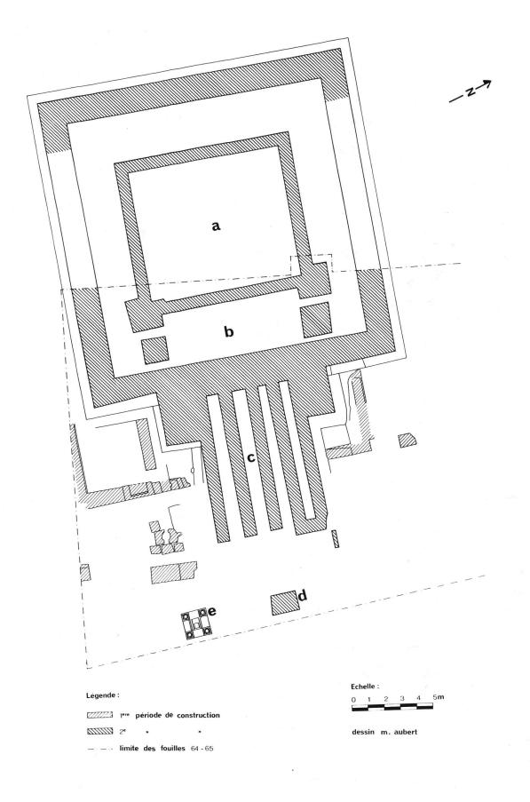
Fig. 22. — Plan général du temple de la Grange-des-Dîmes. a. Cella de plan carré; b. Podium; c. Escalier; d. Autel; e. Tétrastyle.
