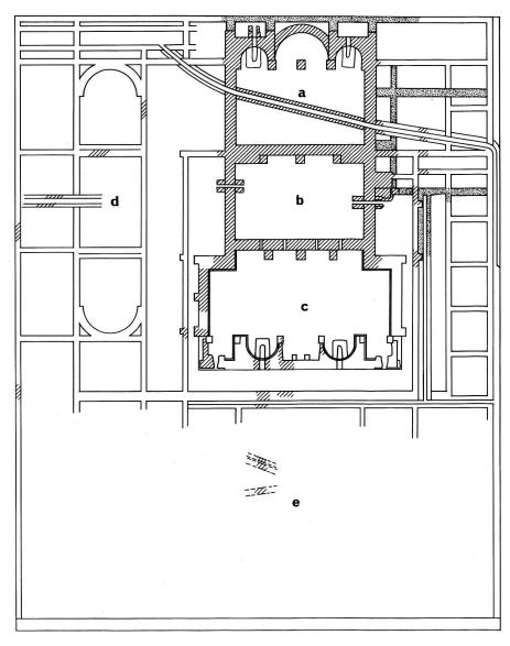
Fig. 23. — Plan général des thermes du Forum ou de Perruet. a. Frigidarium (bassin d'eau froide); b. Tepidarium (bassin d'eau tempérée); c. Caldarium (bassin d'eau chaude); d. Natatio? (piscine de plein air); e. Palaestra (gymnase).
